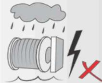
Evite el uso del winche en la lluvia. No moje el interruptor ni el motor.
